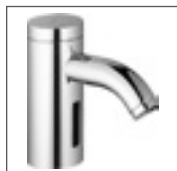
HANSA DESIGNO-E Waschtisch-Elektronik- Batterie, DN 15 Netzbetrieb¹ 5174 2200 verchromt berührungslos elektronisch gesteuert (Infrarot), für Kalt- oder Mischwasser-Anschluss, ohne Zugstangenbohrung Ausladung: 110 mm
