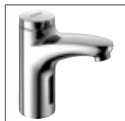
HANSA MIX-E Waschtisch-Elektronik- Batterie, DN 15 Netzbetrieb¹ 5080 1100 verchromt ‡ berührungslos elektronisch gesteuert (Infrarot), ohne Ablaufgarnitur Ausladung: 111 mm
