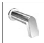
HANSASTECLA Wanneneinlauf, DN 15 (G 1/2)** 5782 2100 verchromt auch kombinierbar zu HANSAMATRIX Ausladung: 160 mm
