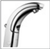
HANSA COBRA Waschtisch-Elektronik- Batterie, DN 15 Netzbetrieb 1 0940 2100 verchromt berührungslos elektronisch gesteuert (Infrarot), flexible Anschlusschläuche Ausladung: 122 mm
