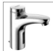
HANSA MIX-E Waschtisch-Elektronik- Batterie, DN 15 Batteriebetrieb 5079 2210 verchromt berührungslos elektronisch gesteuert (Infrarot), Ablaufgarnitur mit Zugbetätigung, flexible Anschlusschläuche Ausladung: 111 mm
