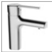
HANSARONDA Waschtisch-Einhand- Einlochbatterie, DN 15 0308 2273 verchromt ohne Ablaufgarnitur, Anschluss mit flexiblen Druckschläuchen Ausladung: 100 mm
