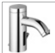
HANSA DESIGNO-E Waschtisch-Elektronik- Batterie, DN 15 Batteriebetrieb 5179 2210 verchromt berührungslos elektronisch gesteuert (Infrarot), Ablaufgarnitur mit Zugbetätigung, flexible Anschlusschläuche Ausladung: 110 mm
