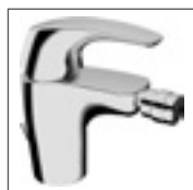
HANSADISC Einhand-Einlochbatterie, DN 15 für Sitzwaschbecken 0102 3274 verchromt Ablaufgarnitur (Metall), Anschluss mit flexiblen Druckschläuchen Ausladung: 112 mm
