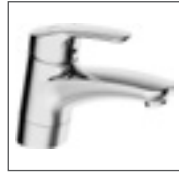
HANSAMIX Waschtisch-Einhand- Einlochbatterie, DN 15 0118 2183 verchromt ohne Ablaufgarnitur, Auslauf schwenkbar, Anschluss über Kupferrohre Ausladung: 157 mm
