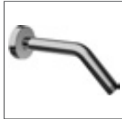
HANSAJET Brausearm, DN 15 5199 0200 verchromt Ausladung: 165 mm
