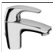
HANSADISC Waschtisch-Einhand- Einlochbatterie, DN 15 0101 2274 verchromt Ablaufgarnitur (Metall), Anschluss mit flexiblen Druckschläuchen Ausladung: 111 mm
