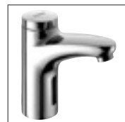
HANSA MIX-E Waschtisch-Elektronik- Batterie, DN 15 Batteriebetrieb 5077 2210 verchromt berührungslos elektronisch gesteuert (Infrarot), ohne Ablaufgarnitur, flexible Anschlusschläuche Ausladung: 111 mm
