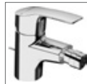
HANSAPOLO Einhand-Einlochbatterie, DN 15 für Sitzwaschbecken 5143 3273 verchromt Ablaufgarnitur (Metall), Anschluss über flexible Druckschläuche Ausladung: 106 mm
