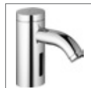
HANSA DESIGNO-E Waschtisch-Elektronik- Batterie, DN 15 Batteriebetrieb 5174 2210 verchromt berührungslos elektronisch gesteuert (Infrarot), für Kalt- oder Mischwasser-Anschluss, ohne Ablaufgarnitur Ausladung: 110 mm
