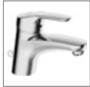
HANSAMIX Waschtisch-Einhand- Einlochbatterie, DN 15 0111 1183 verchromt ohne Ablaufgarnitur, versenkbare Kette, Anschluss über Kupferrohre Ausladung: 141 mm
