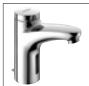
HANSA MIX-E Waschtisch-Elektronik- Batterie, DN 15 Netzbetrieb¹ 5079 2200 verchromt berührungslos elektronisch gesteuert (Infrarot), Ablaufgarnitur mit Zugbetätigung, flexible Anschlusschläuche Ausladung: 111 mm
