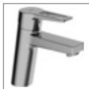
HANSATWIST XL Waschtisch-Einhand- Einlochbatterie, DN 15 0902 2285 verchromt Bügelhebel (Metall), Anschluss mit flexiblen Druckschläuchen, ohne Ablaufgarnitur Ausladung: 123 mm
