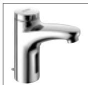
HANSA MIX-E Waschtisch-Elektronik- Batterie, DN 15 Batteriebetrieb 5081 1100 verchromt ‡ für offene Heißwasserbereiter, berührungslos elektronisch gesteuert (Infrarot), Ablaufgarnitur mit Zugbetätigung Ausladung: 111 mm
