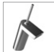
HANSASTELA Waschtisch-Einhand- Einlochbatterie, DN 15 5708 2201 verchromt ohne Ablaufgarnitur, Anschluss mit flexiblen Druckschläuchen Ausladung: 111 mm
