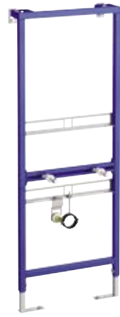
89266.5 CU3 Installationssystem LIS für Urinale mit integrierter Steuerung bzw. wasserlos H/B/T: 120x50x10cm, selbsttragender Stahlrahmen für Trocken- und Maßivbau, für Vor- und Inwandinstallation, Füße höhenverstellbar und drehbar, Anschlüsse voreingestellt für Lema 84019.4 /6 /8 /9, mit Gewindestangen M8 und Befestigungsmaterial.
