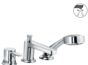
Wannenfüll- und Brause-Einhandmischer DN 15 für Dreiloch-Wannenrandmontage Ausladung 140 mm 384460575 ■
