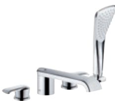
Wannenfüll- und Brausearmatur DN 15 für Vierloch-Fliesenrandmontage Ausladung 220 mm 554250575 ■
