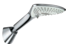
KLUDI FIZZ Kopfbrause DN 15 umstellbar auf drei Strahlarten: Booster, Smooth, Volumen mit justierbarem Kugelgelenk (max. Neigungswinkel 36°) 6758005-00 ■
